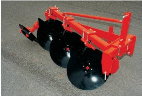
Elle reprend le principe de fonctionnement de la charrue à versoir, en remplaçant tout le corps principal par **un disque de fort diamètre** (0,6 à 1 m) et d'épaisseur importante (6 à 10 mm). Ce disque est de forme concave très marquée (12 à 20 cm de flèche) qui permet une bonne capacité de retournement de la terre. Il dispose généralement d'un **racleur** (ou versoir de disque) interne pour éviter les bourrages et améliorer le retournement.
