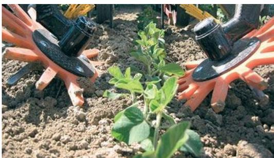
L'efficacité est conditionnée **par le type de doigts** : taille, diamètre et rigidité doivent être adaptés à la culture. Le principale frein à cet équipement généralement disponible en option auprès des constructeurs est son prix : de 350 à 600 € par rang.
