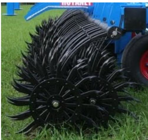
☞ Montage d'**une roue par bras** (ex : constructeur CARRE et YETTER) avec deux longueurs de bras disposant du même type de ressort ou de ressorts différents.
