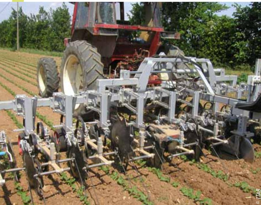
Une bêcheuse pour le désherbage mécanique
